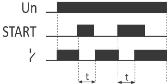
**K.** Désactivation du relais pour une durée déterminée  $t$  déclenchée par le front montant du signal START.
