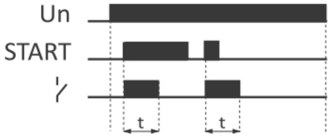
F. Génération d'une impulsion unique de durée  $t$  déclenchée par le front montant du signal START. Pendant la mesure du temps, le système ne réagit pas aux impulsions START.
