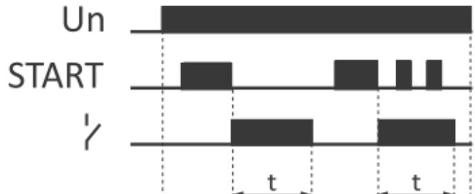
G. Génération d'une impulsion unique de durée  $t$  déclenchée par le front descendant du signal START. Pendant la mesure du temps, le système ne réagit pas aux impulsions START.
