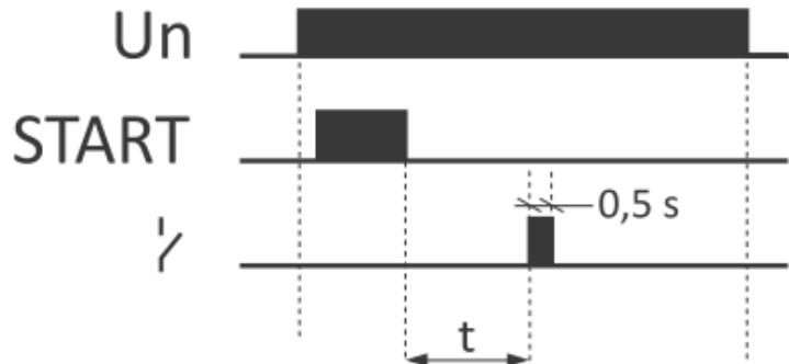
I. Génération d'une impulsion unique de 0,5 s après un temps  $t$  déclenché par le front descendant du signal START.
